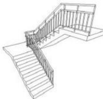
Voorbeeld LOD200 trap + balustrade (links) en LOD300 trap en balustrade (rechts)
