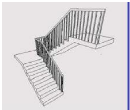
Voorbeeld LOD200 trap + balustrade (links) en LOD300 trap en balustrade (rechts)
