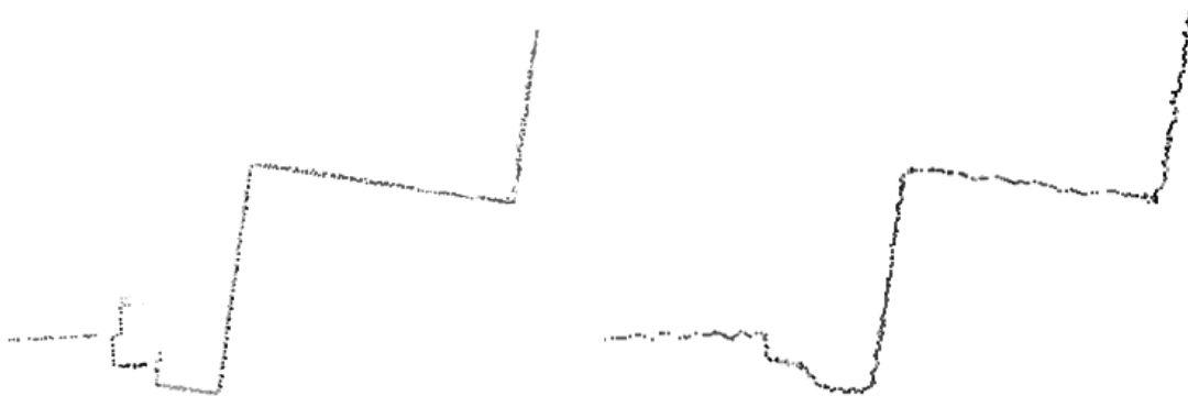
Horizontale pointcloudsnedes over een kozijn en wand. Statische scanner (links) en mobiele scanner (rechts)
