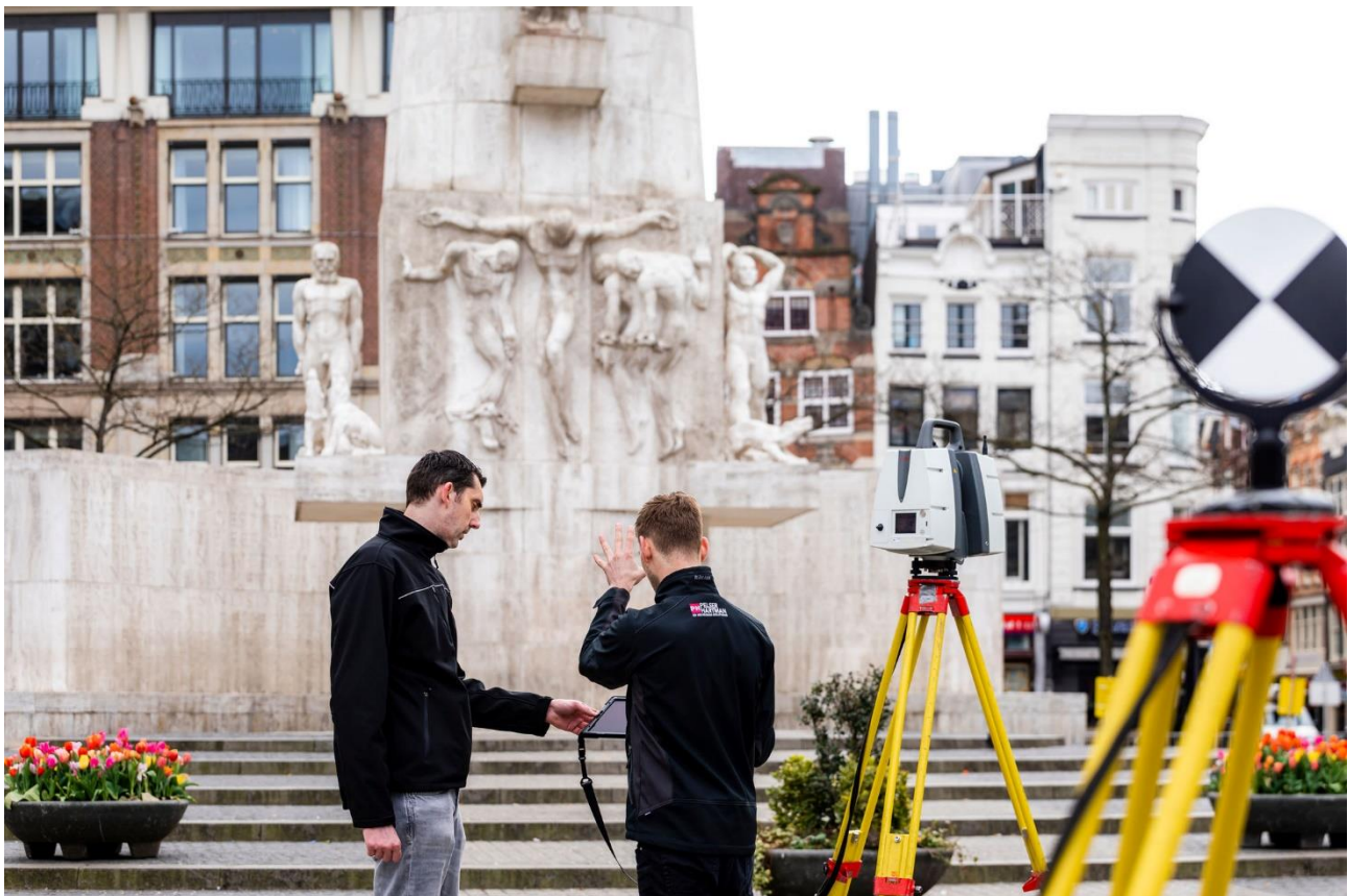
Nulmeting Nationaal monument op de Dam in Amsterdam met high-end 3D laserscanner.
