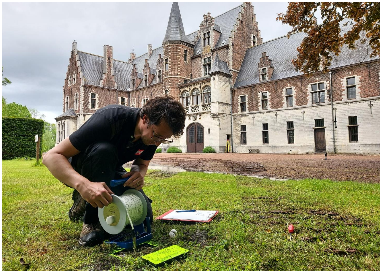
Meting waterstand in peilbuis Rubens Kasteel Elewijt
